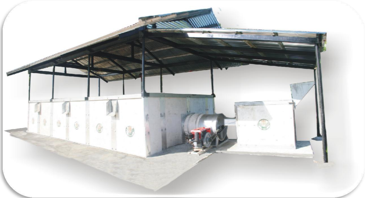
រូបភាពទី ១៨ : ម៉ាស៊ីនសម្ងួតប្រភេទប្រអប់ផ្តេក
