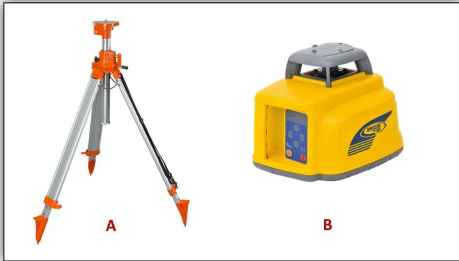
រូបទី១៣ (A) ជើងទម្រង់ប្រឌុបករណ៍បញ្ជូនកាំរស្មីឡាហ្វែរ (B) ឧបករណ៍បញ្ជូនកាំរស្មីឡាហ្វែរ
