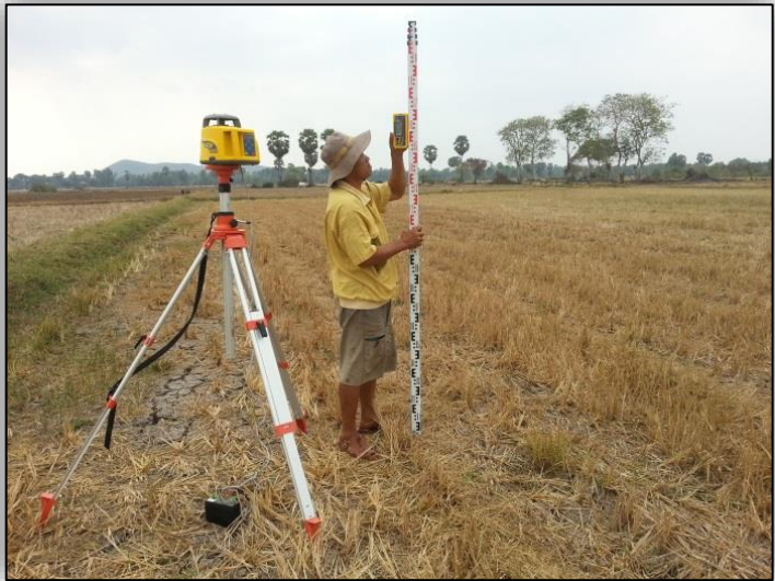
រូបទី២២ ការអនុវត្តន៍វាស់ស្ទង់ដីដោយគ្រឿងបរិក្ខារឡាហ្វែរីន
